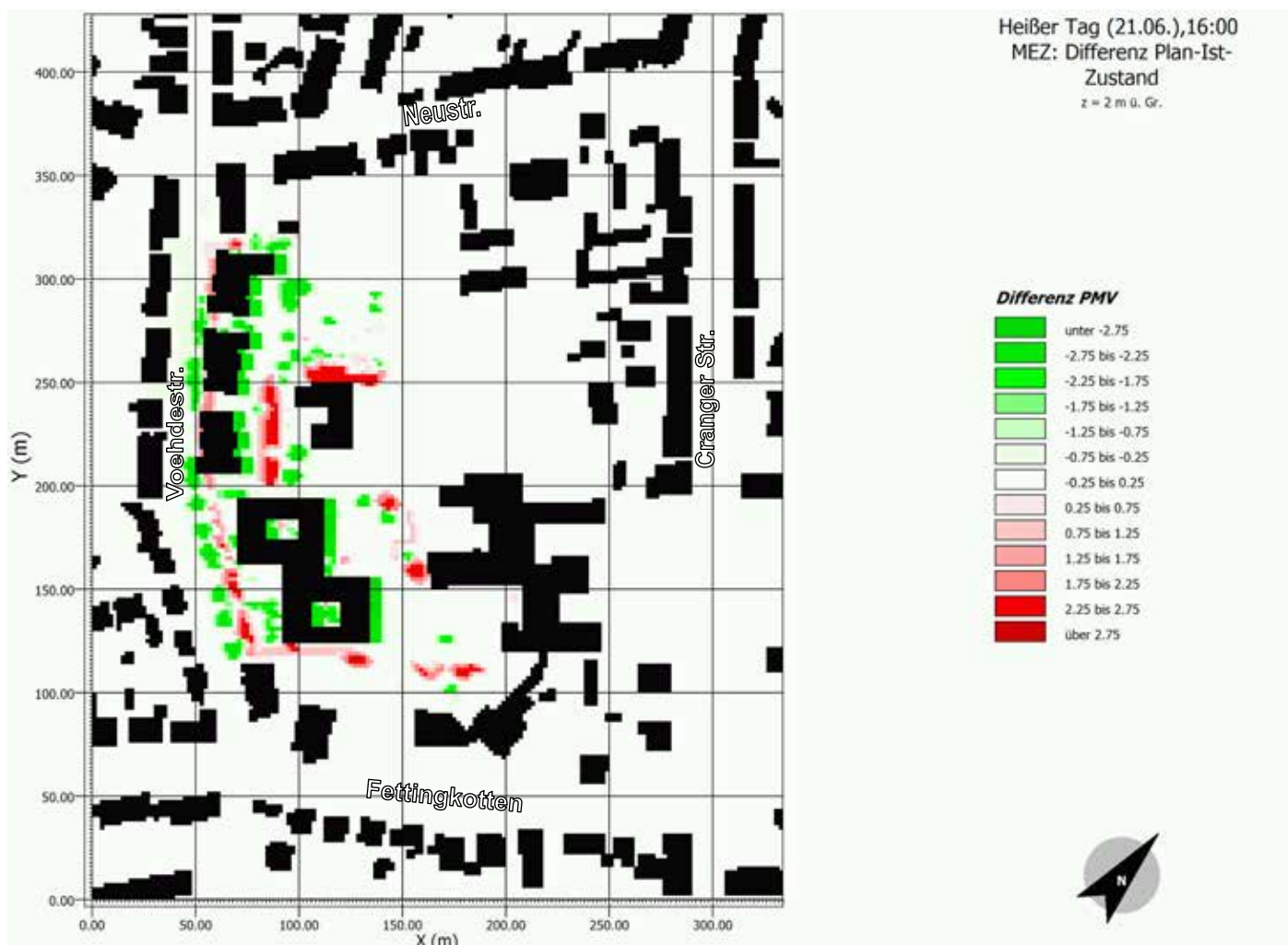
Abb. 20: Differenz der thermischen Behaglichkeit PMV in 2 m ü. Gr. zwischen Plan- und Ist-Zustand des Modellquartieres M1 „Elisabeth-Stift Erle“ in Gelsenkirchen für 16 Uhr MEZ eines windschwachen heißen Tages (21. Juni).
