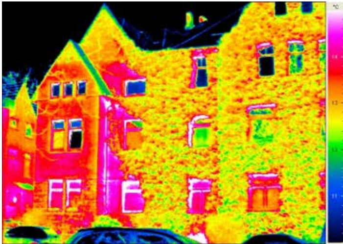
Abb. 4-17 Oberflächentemperaturen einer begrünten (rechts) und unbegrünnten Hauswand (Foto: Mersmann)
